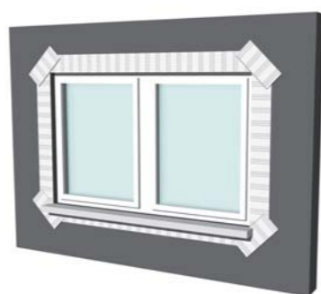
Obrázek č. 8: Vytužení okrajů stavebních otvorů sklotextilní tkaninou
